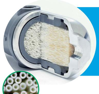
Мембранные установки PRISM® для модернизации биогаза содержат тысячи крошечных полых волокон. Молекулы газа меньшего размера, такие как диоксид углерода и водяной пар, проходят через стенки мембраны, в то время как более крупные молекулы метана перемещаются внутри полых волокон до конца модуля.
